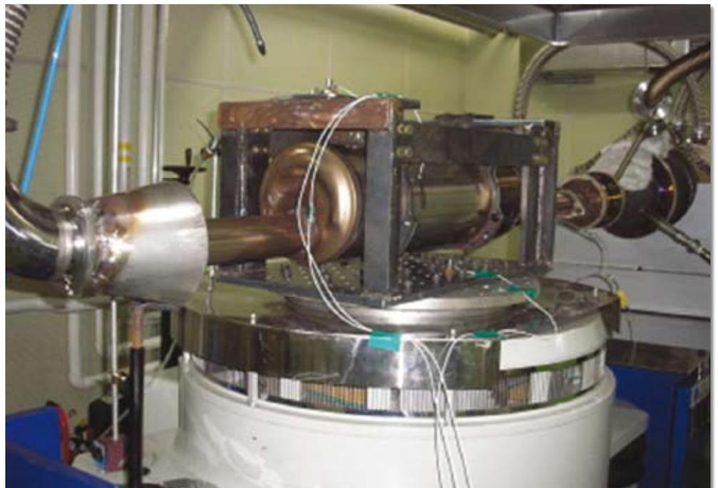
*Les bancs d'essais sont souvent indispensables pour mesurer le stress en fatigue d'un équipement, ici un silencieux d'échappement, et corrélérer ses données avec celles de la simulation.*
