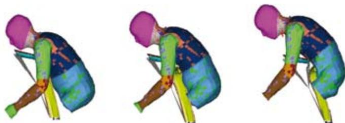
*Des simulations numériques par éléments finis dans Radioss, de Altair, permettent d'étudier en détail les effets du choc sur Humos, le modèle d'homme virtuel.*
